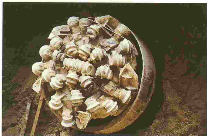
Tunnel est. Le tunnelier pilote (Wirth TB I E) atteint le sommet d'un des deux puits de ventilation de la future centrale des Perrolets, après avoir fraisé 650 m de roche. La tête rotative du tunnelier est équipée d'outils de coupe en métal trempé. A cet endroit, la machine est démontée et évacuée. L'étape suivante consiste en l'élargissement du puits pilote jusqu'au diamètre final ( \phi 5,75 m), de haut en bas, à l'aide d'un tunnelier-alésoir (Wirth TB E IV). Ce système de forage offre, dans des conditions géologiques favorables, de nombreux avantages: aucun hors-profil n'est mis en évidence, ce qui se traduit par un gain de béton, entre autres; les travaux de soutènement se trouvent considérablement réduits; le personnel de chantier est enfin beaucoup mieux protégé que pour tout autre type de creusement. (Photo prise le 13 mai 1987.)
