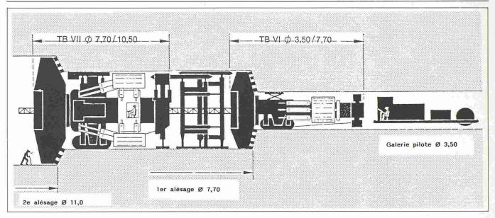
Aléseuses pour passer de 3,50 à 7,70 m et de 7,70 à 10,50 m de diamètre.
