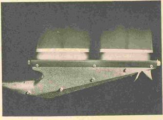
Le brûleur Reminox est un brûleur atmosphérique en fonte, équipé de bandes de tôle ondulée en acier inoxydable. Les parois latérales ainsi que la grille placée au-dessus sont également en acier inoxydable résistant à de hautes températures.
