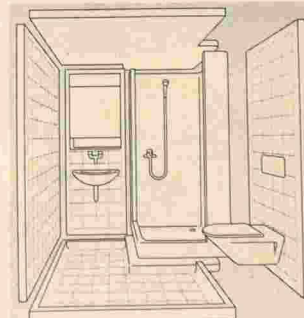
Schéma d'un bloc-eau Ruckstuhl conçu selon le principe modulaire IBS.
