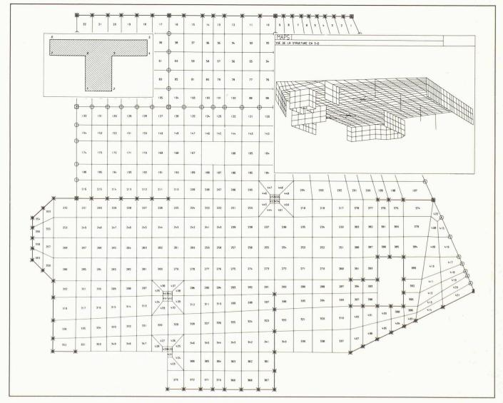
Fig. 3. – Génération par PEGASE d'une dalle avec murs et colonnes – vue en perspective
