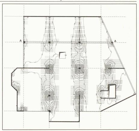
Fig. 8. – Fond de plan pour le dessin des plans d'armatures (nappe supérieure direction 1): classes de hachures donnant les diamètres-espacements et courbes isovales (mettant en évidence la discontinuité des moments au droit du changement d'épaisseur de la dalle le long de l'axe A-A) donnant les moments de couverture.
