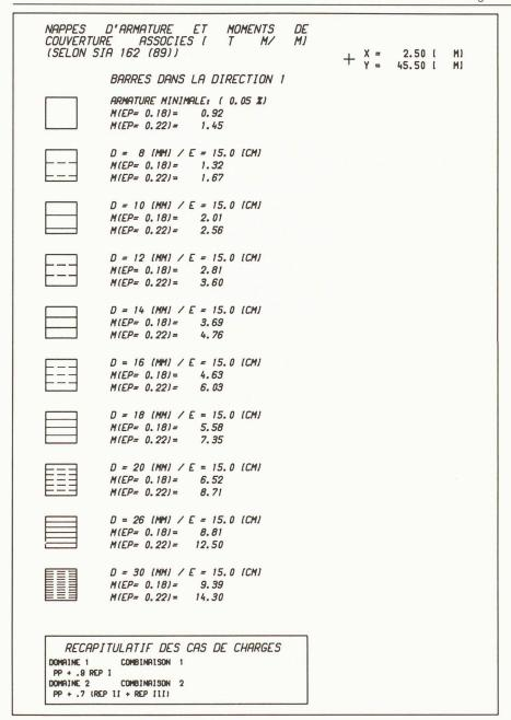
Fig. 7. – Classe de hachures définissant les couplets «diamètres-espacements» et les moments de couverture correspondants pour deux épaisseurs de la dalle.
