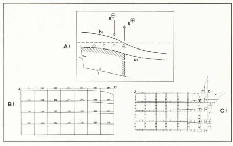
Fig. 4. - Déformation d'une dalle au droit d'un appui sur mur
