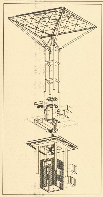
Stansted Airport, Londres. La structure est fondée sur une série de colonnes «à l'arbre», en acier postcompressé. Architectes: Foster Associates.
