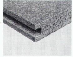
L'HOMOGEN IG V100 est un panneau de particules «trois couches» rendu ignifuge (classe d'incendie V3) par adjonction de sels au bois et à la colle. Ce matériau favorable à l'usinage est au surplus hydrofuge et bénéficie d'un collage exempt de toute formaldéhyde. Il démontre une résistance à la flexion et une stabilité élevées. Demandez nos planches détaillées sur HOMOGEN IG V100. Appelez-nous.
