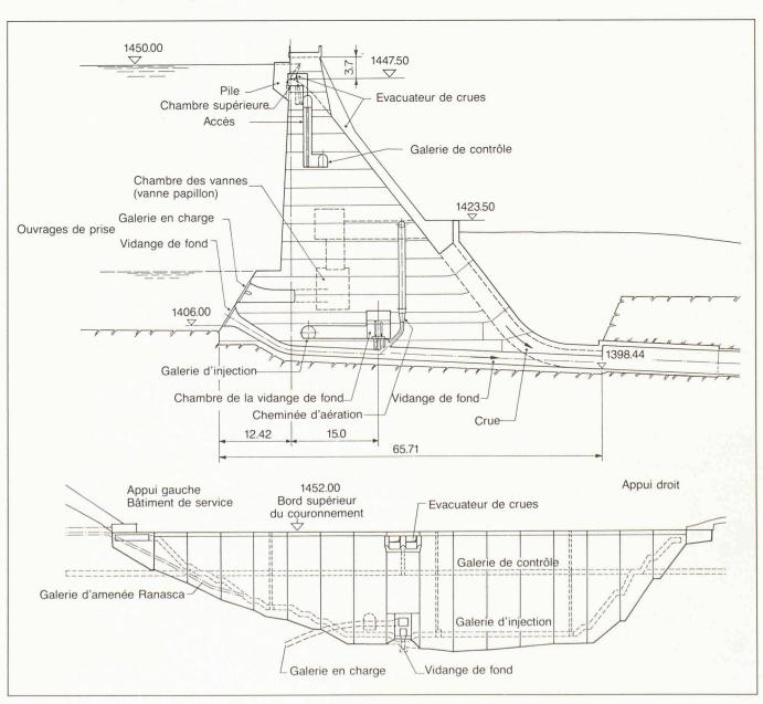
Barrage de Panix: coupes transversale et longitudinale.
