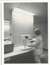
Les composants qui ont été fabriqués et assemblés en atmosphère stérile sont conditionnés sous enveloppes en plastique soudé. L'introduction d'air sous flux laminaire se fait en partie haute, l'extraction en partie basse du plan de travail.
