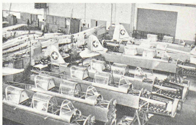
Bois et métal pour le Pilatus P-2 : à gauche, fabrication des ailes dans la menuiserie; à droite, montage des fuselages.
