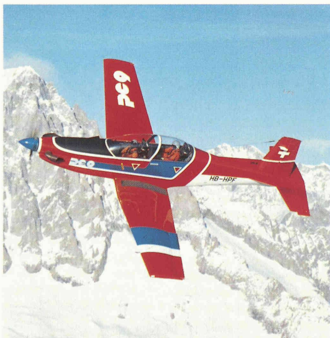
La clé du succès du Pilatus PC-9: combiner les performances d'un avion d'entraînement à réaction aux coûts d'achat et d'exploitation d'un avion à turbopropulseur, grâce à une conception aérodynamique soignée et à une turbine puissante. A droite: le tableau de bord avec ses indications par tubes cathodiques. [Photo Pilatus]
