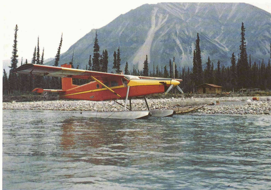
Fabriquée à Stans, montée aux Etats-Unis par Fairchild-Hiller, rebaptisée Heli-Porter et équipée de flotteurs: un Porter dans le Grand-Nord.
