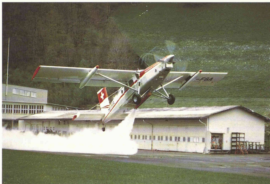
Le Pilatus Turbo-Porter «dopé»: l'installation d'une fusée d'appoint à eau surchauffée POHWARO réduit le roulement au décollage à quelques mètres. Cette combinaison mise au point par Pilatus et la Fabrique fédérale d'avions d'Emmen a notamment été présentée en 1972 à l'exposition aéronautique internationale de Hanovre. [Photo J.-P. Weibel]
