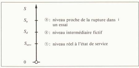
Fig. 1. - Niveaux de charge conduisant aux sollicitations S.
