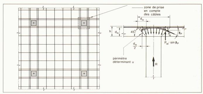
Fig. 3. - Contribution de la précontrainte à la résistance au poinçonnement.
