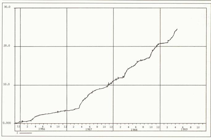
Fig. 1. – Eboulement des Crêtaux; déplacement de la masse centrale du 15 novembre 1985 au 15 mai 1989 (en mètres).
