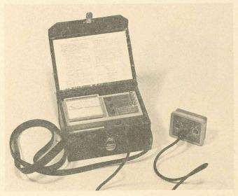
Testé depuis quelques années et constamment perfectionné, cet appareil électronique portatif est destiné à la mesure de l'humidité non destructive dans les matériaux inorganiques et organiques. Les mesures d'humidité s'effectuent par évaluation directe de la modification de la résistance capacitive en fonction de la teneur en eau du matériau à examiner. Comme la constante diélectrique de l'eau est 75 fois supérieure à celle de l'air, on arrive à une sensibilité élevée.
