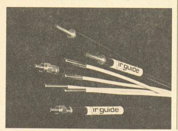
Fluoré permettent de guider la lumière dans une très large plage spectrale, allant de 0,3  $\mu$ m dans l'ultra-violet à 5  $\mu$ m dans l'infrarouge. Dans sa zone d'ultratransparence, entre 1,7  $\mu$ m et 3,5  $\mu$ m l'atténuation est inférieure à 50 dB/km.
