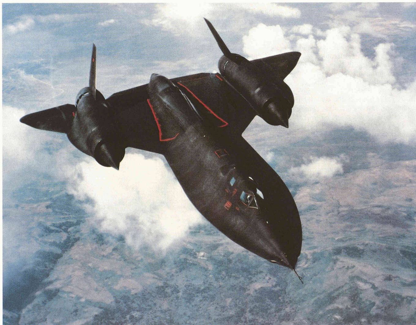
Un SR-71 en vol subsonique. On distingue sur les ailes, entre le fuselage et les réacteurs ainsi que derrière l'aile droite, les traînées de carburant s'échappant des réservoirs structuraux, qui ne deviendront étanches que grâce à la dilatation thermique de la structure à grande vitesse.
