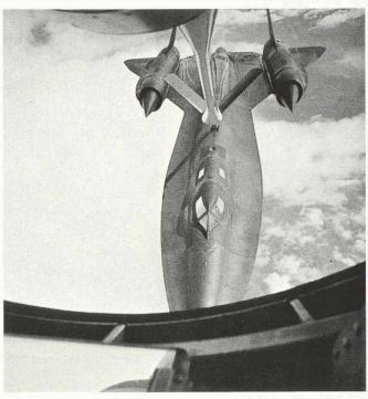
Le ravitaillement en vol, vu du poste de l'opérateur (qui est couché à l'arrière du fuselage). On voit les deux ailettes qui servent à guider le boom vers le réceptacle du SR-71.
