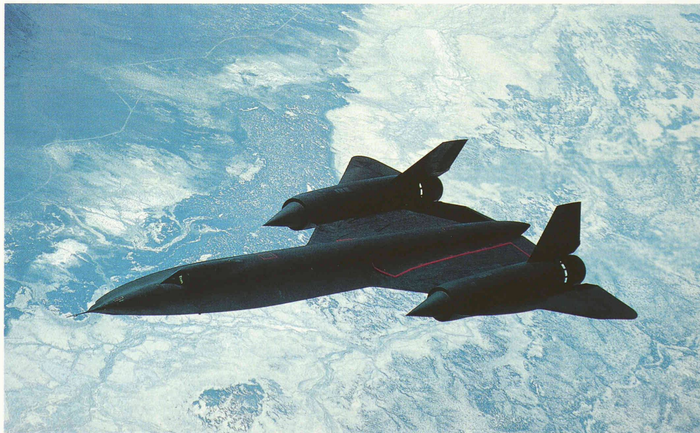
Le Lockheed SR-71A Blackbird en vol à haute altitude (le suffixe A désigne la version opérationnelle; le SR-71B est un avion d'entraînement à double commande, sans équipement de reconnaissance). Le rectangle entouré de rouge, derrière les postes de pilotage et du RSO, montre l'emplacement de la prise (fermée ici) pour le ravitaillement de carburant en vol. A l'arrière des réacteurs, on distingue les prises d'air supplémentaires ouvertes.
