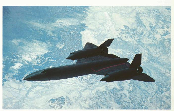
Le Lockheed SR-71A Blackbird en vol à haute altitude (le suffixe A désigne la version opérationnelle; le SR-71B est un avion d'entraînement à double commande, sans équipement de reconnaissance). Le rectangle entouré de rouge, derrière les postes de pilotage et du RSO, montre l'emplacement de la prise (fermée ici) pour le ravitaillement de carburant en vol. À l'arrière des réacteurs, on distingue les prises d'air supplémentaires ouvertes. (Photo USAF/Weibel.)
