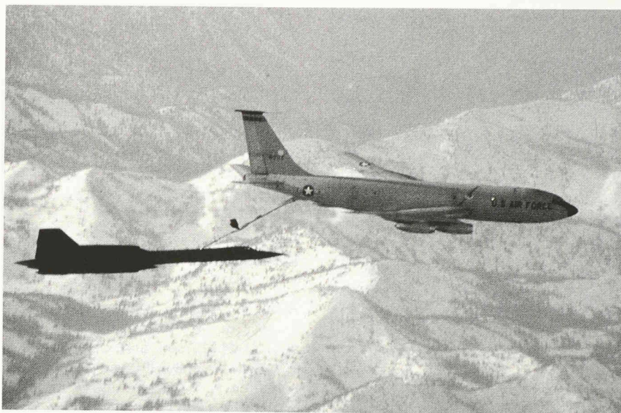
Ravitaillement en vol. La différence d'angle d'attaque du SR-71 et du KC-135Q montre que les deux avions volent aux limites opposées de leurs domaines de vol respectifs. Cette photographie est tirée du livre de Paul F. Crickmore SR-71 Blackbird, édité par Dennis Baldry, Londres, 1988, qui rassemble une magnifique série de photographies en couleurs illustrant tous les aspects du service de vol de cet avion: un «must» pour l'amateur!
