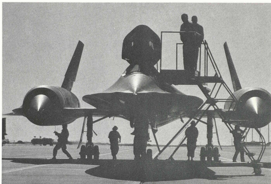
Cette photographie illustre l'équipement spécial nécessaire à l'exploitation du SR-71: ses formes exotiques, par exemple, exigent des échelles adaptées. Cela n'est que l'un des aspects des problèmes posés par un éventuel atterrissage hors d'une des bases équipées.
