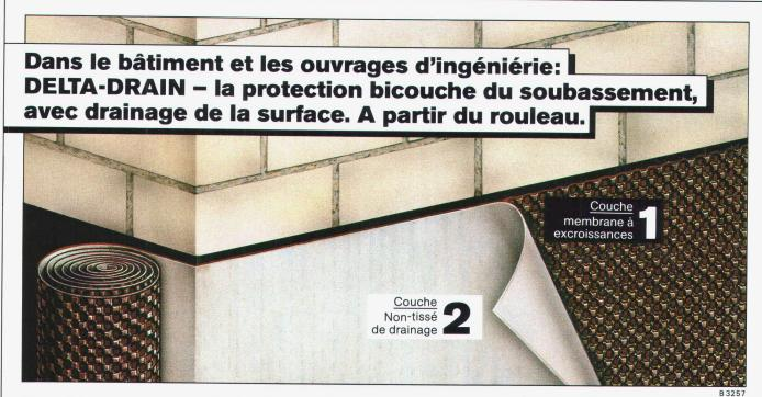
Couche 1: les excroissances tournées vers l'ouvrage séparent sûrement et durablement cules fines (jusqu'à 20 µm). Le le mur du soubassement du sol humide, assurent une meilleure isolation thermique et protègent la couche d'étanchéité.
