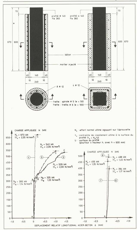
Fig. 2. - Description des essais «push-out».
