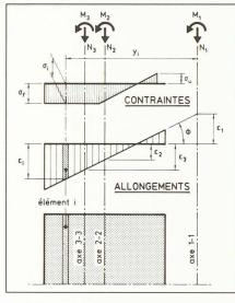
Fig. 4. – Détermination de la rigidité flexionnelle
