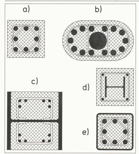
Fig. 1. – Les différents types de sections mixtes:
