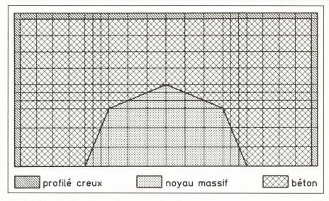
Fig. 3. - Modélisation des sections avec «Colmixte».
