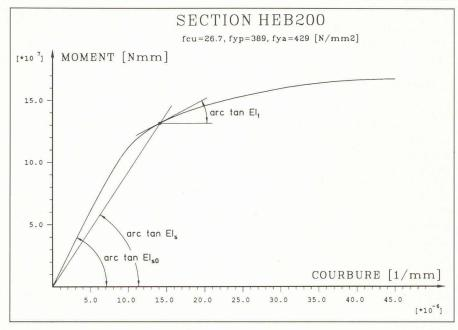
Fig. 5. - Relation moment - courbure d'une section mixte.
