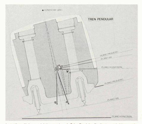
Le système dit de « pendulation passive » du Talgo Pendular : l'inclinaison est obtenue automatiquement par l'accélération centrifuge, le centre de rotation (imposé par la cinématique de la suspension) se trouvant au-dessus du centre de gravité de la caisse. Cette disposition ne permet qu'une compensation inférieure à celle d'un système actif, son coût est faible et son fonctionnement d'une grande douceur.
