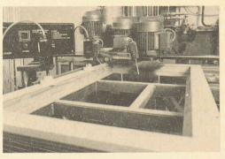
Fig. 5. - Fenêtre EgoKiefer en carrelets lamellés.
