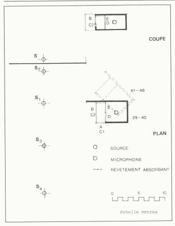
Fig. 4. – Loggia partiellement vitrée – Expériences 29 à 34 et 35 à 46.
