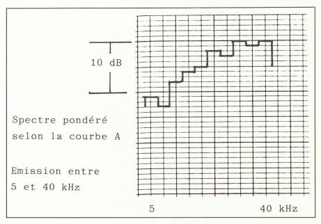
Fig. 1. – Exemple du spectre d'émission à 1 m de distance, latéralement.
