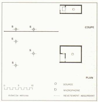
Fig. 3. – Effet d'une loggia sur le niveau du bruit perçu – Expériences
