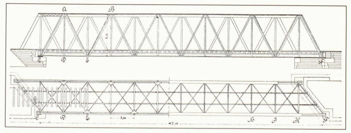
Fig. 5. – Variante de l'entreprise Eiffel & Comp. pour le pont sur la Birse à Münchenstein (variante exécutée en 1874-1875).
