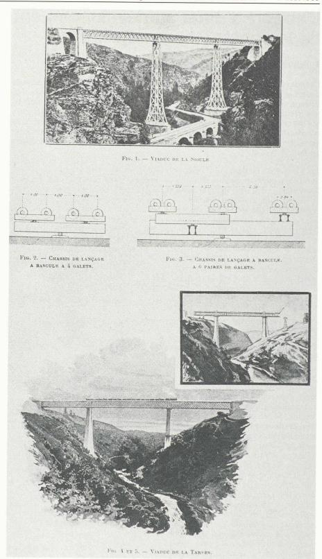
Fig. 2. – Viaduc de la Sioule : détails des châssis de lançage à bascule. Planche extraite de la Biographie industrielle et scientifique, tome I, Paris, Musée d'Orsay, fonds Eiffel.
