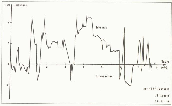
Fig. 3. - Mesure de la puissance transitant par le moteur.
