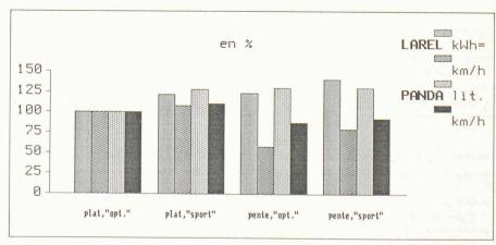
Fig. 4. - Comparaison des consommations au kilomètre et des vitesses moyennes.
