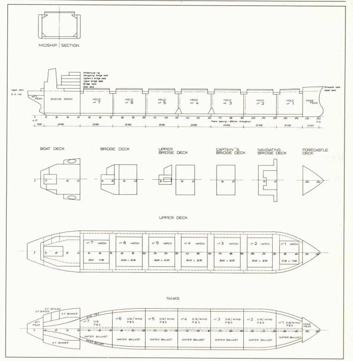
Fig. 1. - Disposition des cales.
