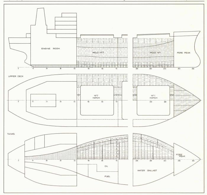
Fig. 3. - Disposition des écoutilles.
