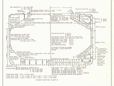
Fig. 2. - Carène et structure.
