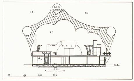
Fig. 12. - Section transversale de la structure pneumatique mixte.
