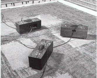
Test des bruits d'impacts dans des conditions réelles (sous-plancher continu, temps prolongé de mise en charge) avec frappeurs. EMPA Zurich.
