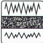
**Resobloc®** est un nouveau développement d'appuis acoustiques de Kilcher. Il est composé de caoutchouc granulaire neuf, lié au polyuréthane. Une pellicule spéciale sur la face supérieure neutralise les remontées d'humidité. Pour pose sous parois porteuses et non-porteuses de constructions nouvelles.
