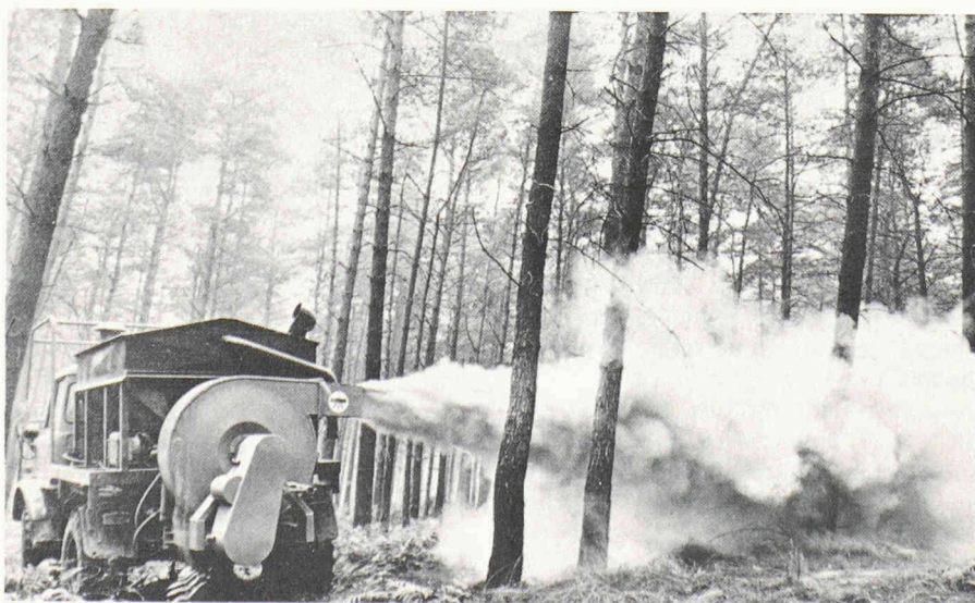
Chaulage de la forêt contre les sols acides. En vue d'endiguer le dépérissement des forêts, on a répandu mécaniquement du carbonate de chaux au magnésium enrichi de phosphates pour protéger les cultures forestières proches des grands centres industriels, par exemple dans la région de la Ruhr.
