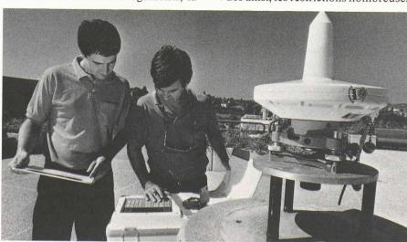
Mise en œuvre d'un récepteur GPS (géodésie par satellite). Test de précision à l'EPFL.
