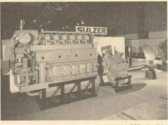
Moteur diesel semi-rapide à six cylindres de la série S20, tel qu'il fut présenté à la SMM'88 de Hambourg.
