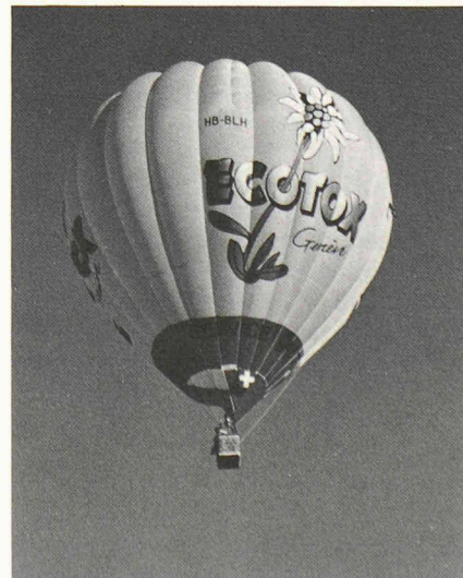
Le ballon Ecotox en vol. Ce ballon permet de faire des mesures des oxydes d'azote et de l'ozone.
