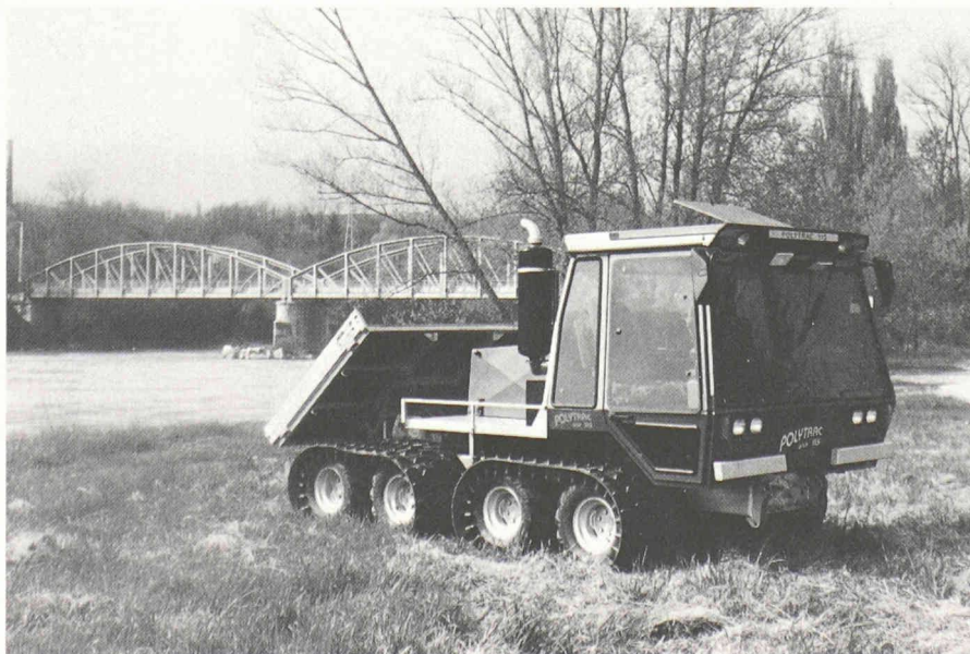
Véhicule Polytrac à entraînement entièrement hydrostatique 8 × 8.
