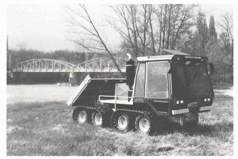
Véhicule Polytrac à entraı̂nement entièrement hydrostatique  $8 \times 8$ .
