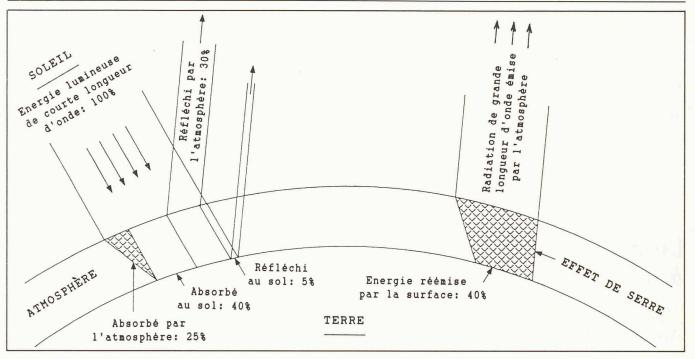
Fig. 1. – Equilibre énergétique entre la radiation lumineuse reçue du Soleil, principalement aux longueurs d'ondes de la partie visible du spectre, et celle réémise par la Terre dans l'infrarouge. 35 % environ de l'énergie solaire incidente sont renvoyés directement vers l'espace, comme par un miroir. Ce rapport constitue ce qu'on entend par «albédo moyen de la planète Terre».
