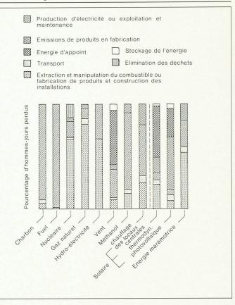
Fig. 2. – Répartition des risques suivant leur origine pour les différents systèmes de production d'énergie.
