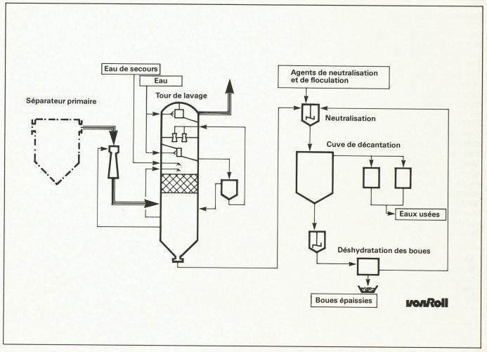
Fig. 4. – Lavage humide et traitement des eaux usées.
