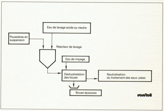
Fig. 5. - Traitement des poussières en suspension.
