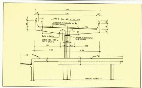
Fig. 7. - Coupe type sur le viaduc.
