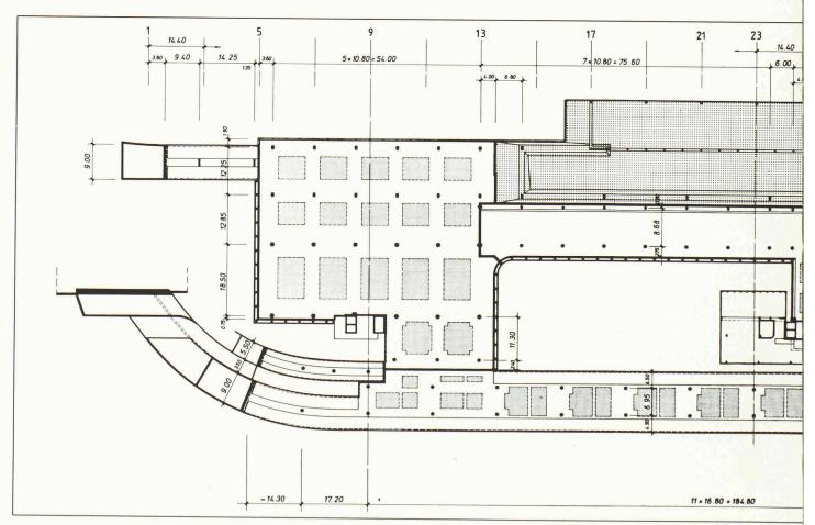
Fig. 5. - Plan d'ensemble des «ponts-dalles», au niveau «Enregistrement».
