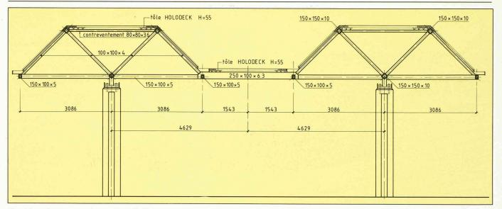
Fig. 15. – Coupe sur charpente métallique.
