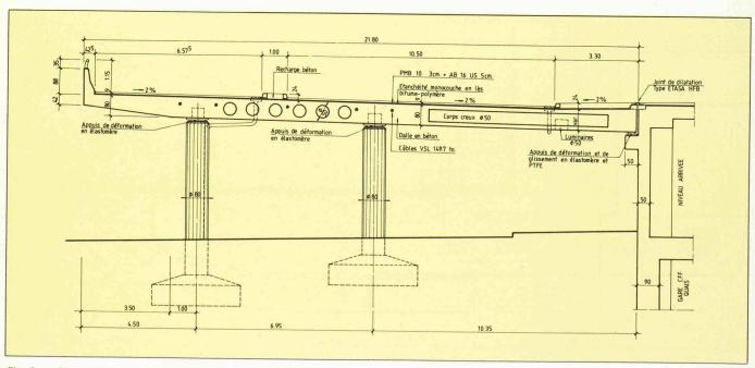
Fig. 9. - Coupe type sur la dalle plate-forme devant la gare CFF (axe 45).
