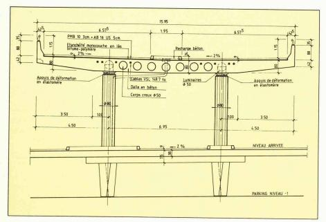
Fig. 8. - Coupe type sur la rampe de sortie.
