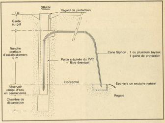
Composition d'un drain siphon isolé, complet.
