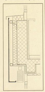
Fig. 1. – Structure de l'habillage Armafil.
