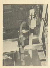
Par l'intermédiaire d'une caméra de télévision, le système d'analyse d'images Videomat saisit automatiquement le repère d'identification tel que code ou écriture, et transmet les informations à un ordinateur pilote ou à une commande pour la fabrication. Le système Videomat est également capable de lire des trous percés ou estampés.
