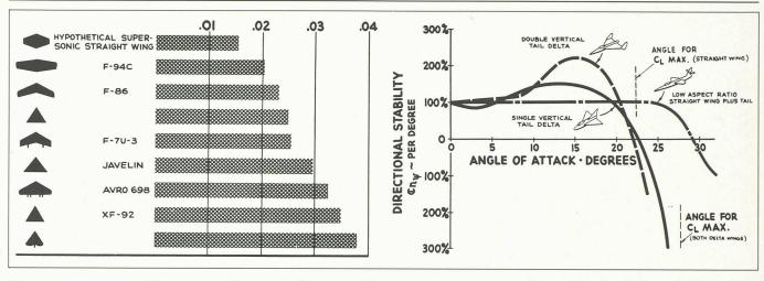
Ces comparaisons, pour divers types ou diverses configurations d'avion, de la surface alaire par unité de poids (à gauche) et stabilité directionnelle en fonction de l'angle d'attaque, indiquaient à l'observateur averti dans quelle direction s'était orienté Lockheed pour la conception de l'avion qui allait incessamment faire son premier vol : le F-104 doté de l'«hypothetical supersonic straight wing»!
