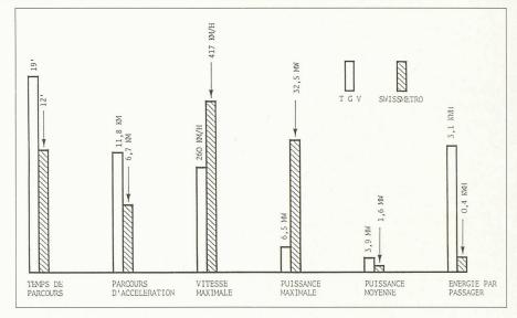
Fig. 4. – Performances comparées TGV-Swissmétro pour un tronçon type de 70 km.
