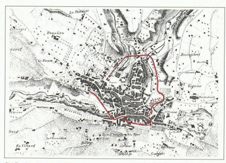
Fig. 7. – Lausanne en 1838 avec, en surimpression, le projet de ceinture. Le trait discontinu correspond aux passages encore mal définis. La percée Saint-Pierre sera exécutée selon ce tracé mais sera rélargie avant l'achèvement des travaux. En revanche, la route joignant le Tunnel à la rue Neuve sera rapprochée de la place de la Riponne, de façon à s'intégrer au projet d'ouverture de la rue Haldimand.
