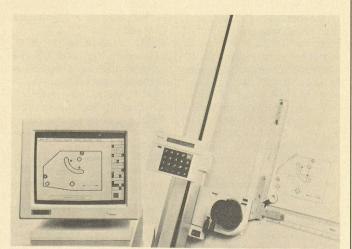
NesCAD draft représente le lien entre la machine à dessiner intelligente NC draft 90/20 et le logiciel performant NesCAD PC CAD. Domaine principal de mise en œuvre: numérisation et traitement ultérieur simples et économiques de dessins de construction.
