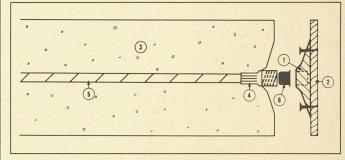
Fig. 1. – Le capuchon en Alcryn (1) est cloué au coffrage (2) afin d'éviter que le béton (3) ne se glisse à l'intérieur du coupleur Bargrip (4) vissé sur l'extrémité du fer à béton (5). Le filetage du coupleur est protégé par un élément (6) réalisé lui aussi en Alcryn.
