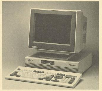
Un processeur 80386 cadencé à 20 MHz est le cœur rapide du nouveau serveur de fichiers T8500 de Toshiba. Avec un disque dur extensible à 200 Mo, il se prête aussi à des applications d'envergure.
