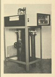
Pour respecter les prescriptions légales de rejet, les eaux usées acides et alcalines provenant de l'industrie doivent être neutralisées avant qu'elles ne s'écoulent dans la station communale d'épuration.
