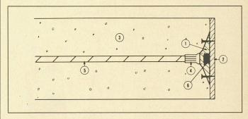
Fig. 2. – Après avoir enlevé le coffrage (2), le capuchon (1) et le protecteur de filetage (6), on accède facilement au coupleur (4) pour y visser l'extrémité filetée de la barre suivante.
