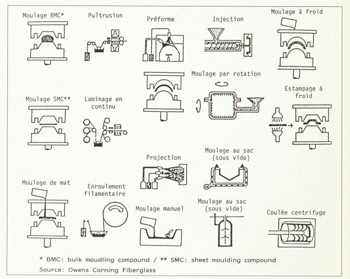
Fig. 4. - Composites à matrice polymérique - Principaux procédés de fabrication des composites.
