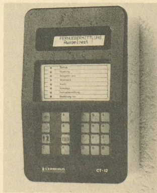
La commande proprement dite s'effectue à l'aide d'un mot de passe et par l'intermédiaire de ce petit appareil commandé à distance, facile à placer discrètement partout. L'état de l'installation est constamment affiché en clair. (Photo: Cerberus AG.)
