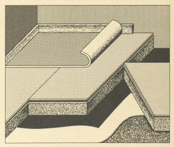
Construction d'un plancher sec en panneaux d'isolation Pavatex
