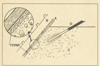
Le polypropylène thermosoudé Typar sert de couche drainante entre la doublure en bois A du coffrage métallique B et le béton C; il favorise l'élimination par vibration D des bulles d'air du béton fraîchement coulé de l'évacuateur de crues du barrage de Karakaya.
