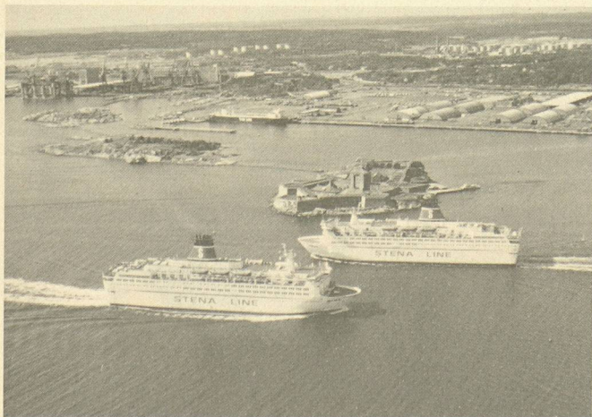
Les transbordeurs Stena Danica et Stena Jutlandica sont propulsés chacun par quatre moteurs diesel 12ZV40 à quatre temps de Sulzer, développant une puissance totale de 25 590 kW (34 800 ch). (Photo d'usine Sulzer.)
