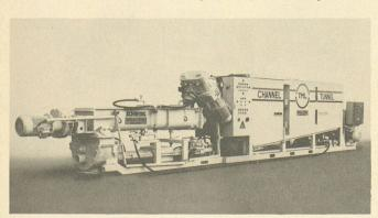
Station de remplissage de mortier.
