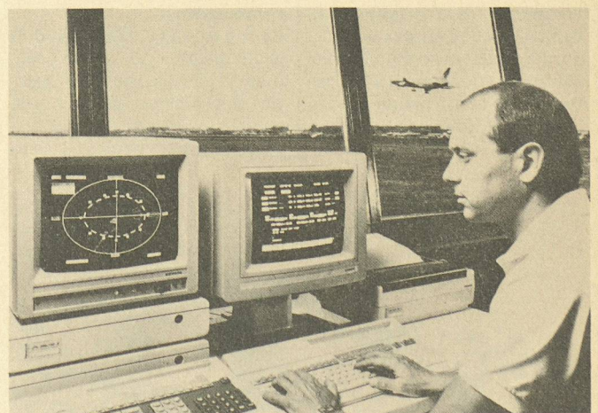
Le système météorologique pour aéroports Siport MET de Siemens assure la collecte automatique des données météorologiques, leur contrôle, leur calcul, leur traitement, leur diffusion et leur archivage. Il facilite la tâche du service météorologique et contribue à l'accroissement de la sécurité de la circulation aérienne.
