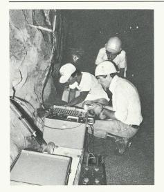
Fig. 10. - Sismographe à 12 canaux.
