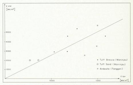
Fig. 14. – Relation module élastique/statique-module dynamique.
