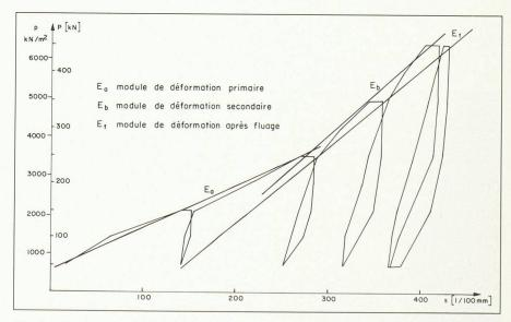
Fig. 9. - Essai de plaque: cycles de charge-décharge.
