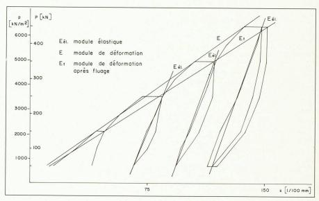
Fig. 8. - Essai de plaque: cycles de charge-décharge.
