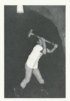
Fig. 11. – Petite sismique: coup de masse sur le parement.
