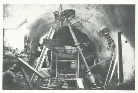
Fig. 1. - Essai de plaque en galerie.
