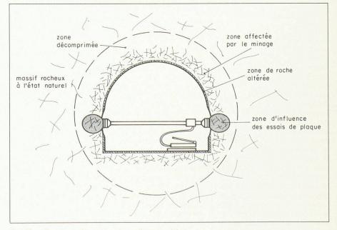
Fig. 15. - Zones rocheuses autour d'une cavité.
