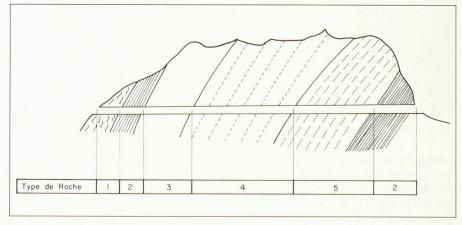
Fig. 2. - Définition des tronçons sur la base de la géologie.
