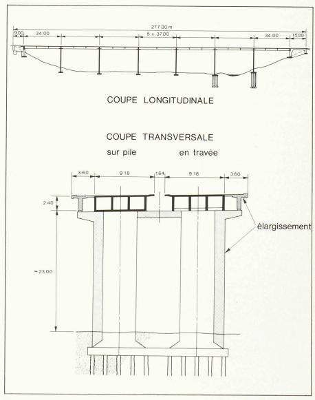
Fig. 1. – Pont sur l'Aubonne de 1962 a) coupe longitudinale
