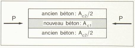
Fig. 4. - Modèle de calcul (vue en plan).
