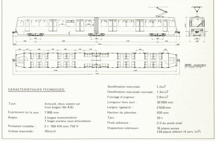
Fig. 2. - Automotrice du TSOL (données de l'avant-projet).
