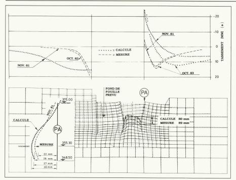
Fig. 7. - Confédération Centre: déformations calculées et mesurées.
