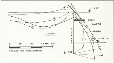
Fig. 5. - Grand Casino: déformations calculées et mesurées.
