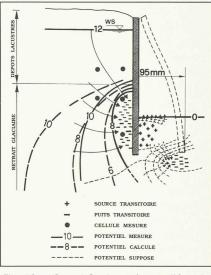
Fig. 10. – Grand Casino: réseau d'écoulement derrière la paroi, mesures et calcul couplé.
