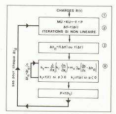
Fig. 12. – Ordinogramme d'un modèle couplé.
