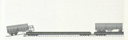
La «chaussée roulante»: les poids lourds (camions, remorques, semi-remorques avec leurs tracteurs) sont chargés sur des wagons surbaissés (8 essieux, 18 m de long, charge utile 42 t). L'accès et le déchargement s'effectuent frontalement, en avant. Les chauffeurs voyagent dans le même train (voiture-lits).
