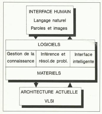
Fig. 3. - Architecture d'un KIPS.
