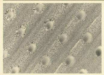
Photographie au microscope électronique sur laquelle on distingue très nettement les zones circulaires amorphes, de 1 µ de diamètre, que contient le matériau cristallin. On voit en haut à gauche comment se recristallise la périphérie de ces zones amorphes lors de l'effacement. La photo représente un composé de tellure, sélénium et antimoine, qui est l'un des matériaux expérimentés dans le cadre des recherches sur l'enregistrement optique effaçable.
