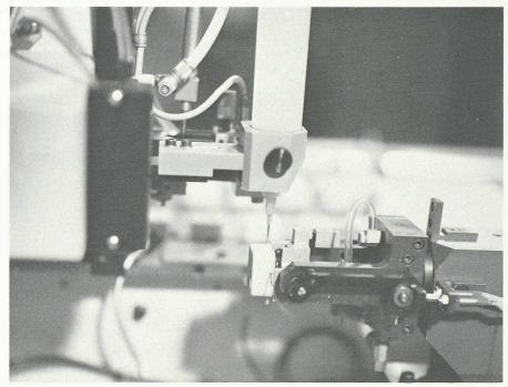
Fig. 2. – Robot déposant un joint de résine d'étanchéité sur le pourtour d'un boîtier de relais. (Photo Automelec SA.)
