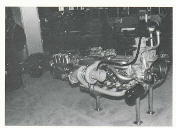
Technique hybride (Mercedes): combinaison de la traction électrique et d'un moteur diesel, combinant le silence et la souplesse du premier avec l'indépendance du second quant à l'infrastructure.
