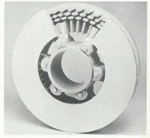
Technique ferroviaire moderne de freinage (Lucas Girling): frein à disque compact sur la transmission, à gauche, et disque de frein de conception aérodynamique optimalisée pour l'économie d'énergie en phase non freinée (moins de 1 kW à 225 km/h pour un diamètre de 640 mm).
