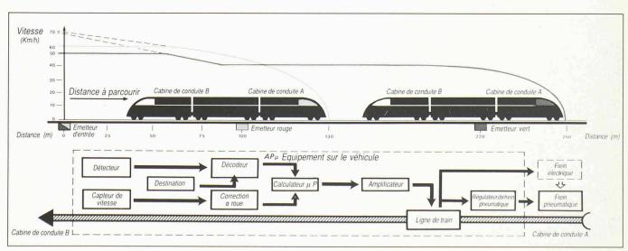
Système de commande automatique BBC-Sécheron d'arrêt des trains sur 130 ou 250 m.
