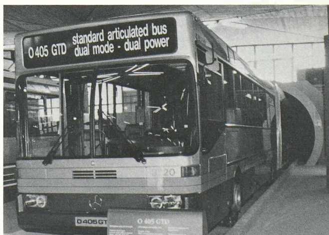
Utilisation parcimonieuse de la voirie urbaine par la précision du cheminement (Mercedes) : autobus articulé avec guidage forcé en site urbain, équipé du moteur hybride.
