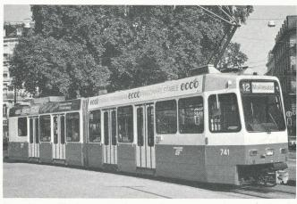
Pour leur utilisation optimale, des tramways modernes – c'est-àdire rapides, confortables et munis de planchers surbaissés) – comme ce modèle Vevey/Düwag destiné à Genève supposent un réseau bien protégé des aléas de la circulation automobile. C'est bien là que les limites pratiques se font cruellement sentir à Genève. (Photo Vevey.)
